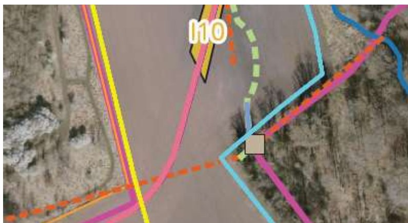
Figur 6: Omlægning af tilløb (Orange stiplede linje) til ny grøft (grøn stiplede linje). Eksisterende grøft opfyldes 10 m nedstrøms forlægningspunktet (grå firkant). Der etableres en 20 m lang rørbrø. For øvrig tegnforklaring henvises til Bilag 2.
