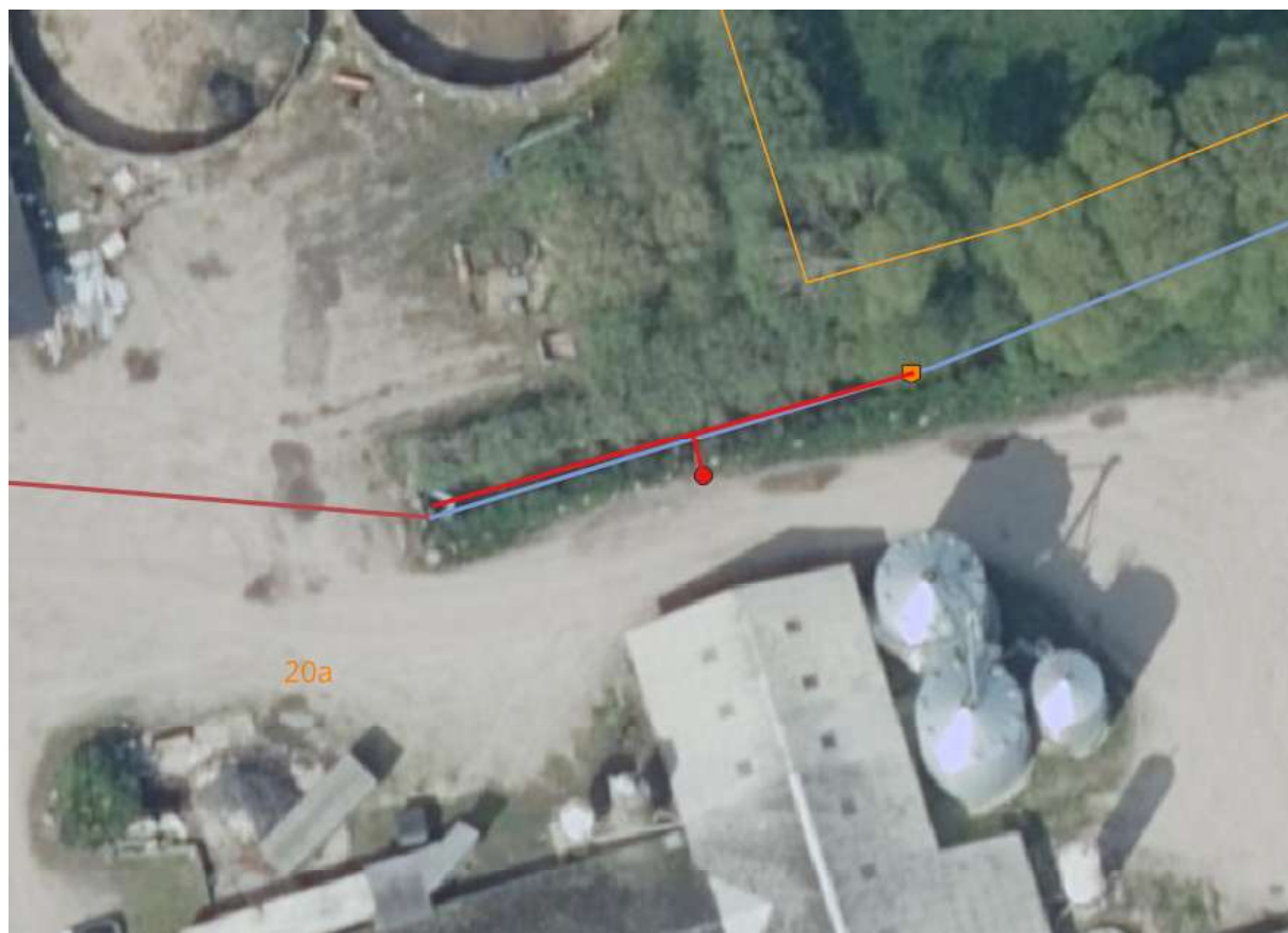
Figur 4-2: Oversigtskort med angivelse af rørlægning i gårdsplads. Nye rørlægninger er angivet med rød streg, ny brønd er angivet med rød markering og flytning af stensikring er angivet med orange markering. For øvrig tegnforklaring henvises til Bilag 2.
