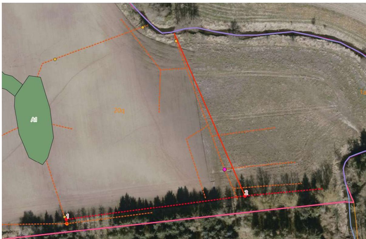
Figur 5: Oversigtskort med angivelse af nyt drænsystem. Nye dræn er angivet med stiplet rød streg, nye tætte ledninger er angivet med fuldt optrukket rød streg og nye brønde er angivet med rød markering og nr. 1 og 2. For øvrig tegnforklaring henvises til Bilag 2.
